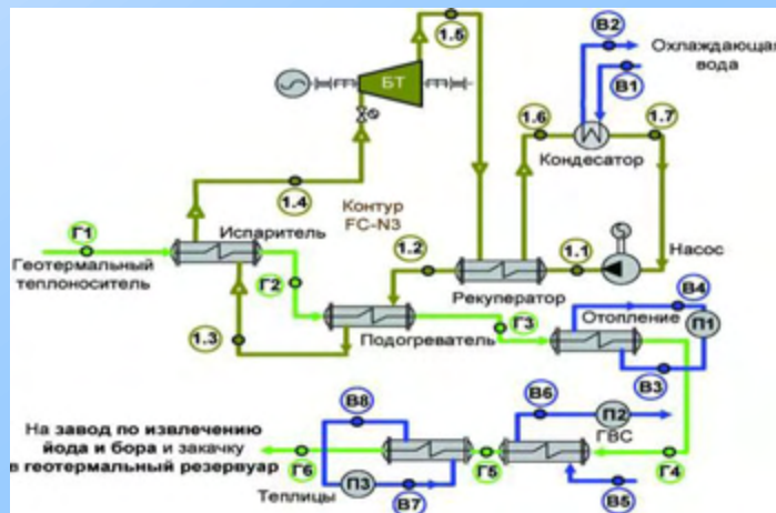
Принципиальная схема использования геотермальных ресурсов для тепло- и электроснабжения г. Усть-Лабинска (тов < +8 оС)
